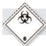
CL. 6.2 PERICOLO BIOLOGICO
